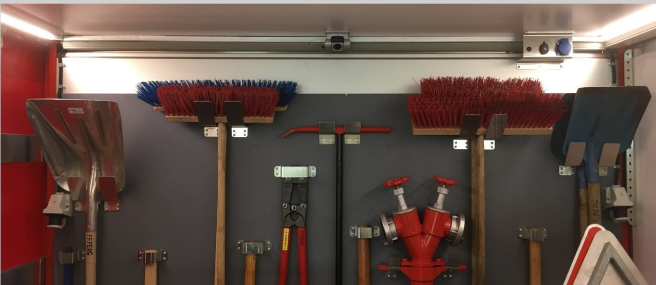
Laderaum mit LED-Streifen beleuchtet, Kamera zur Laderaumüberwachung und Stromversorgung an der Stirnwand
