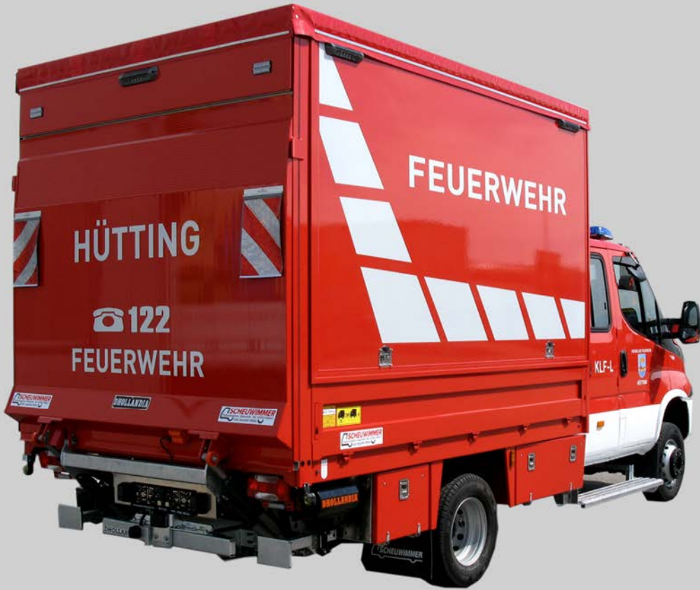
Ladebordwand mit verzinktem Hubgerüst
