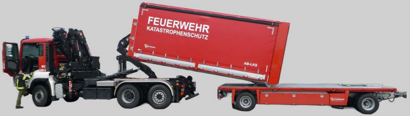
Abrollbrücke zur Nutzung am Drehschemel-Anhänger
