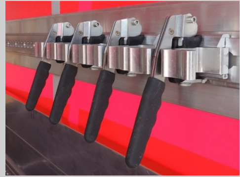
Ein sicheres System - mittels Klemme werden die Rollcontainer gesichert
