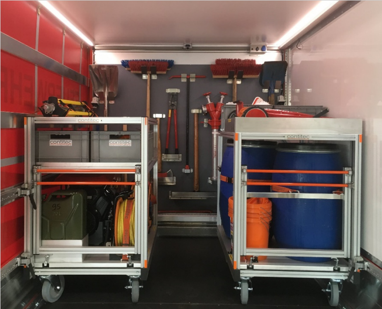
Laderaum mit LED-Streifen beleuchtet, Kamera zur Laderaumüberwachung und Stromversorgung an der Stirnwand
