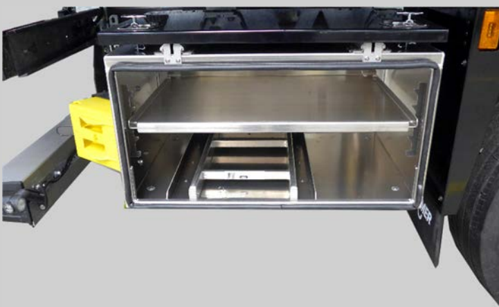
Staubox quer zur Fahrtrichtung, Staumöglichkeit für Leiter
