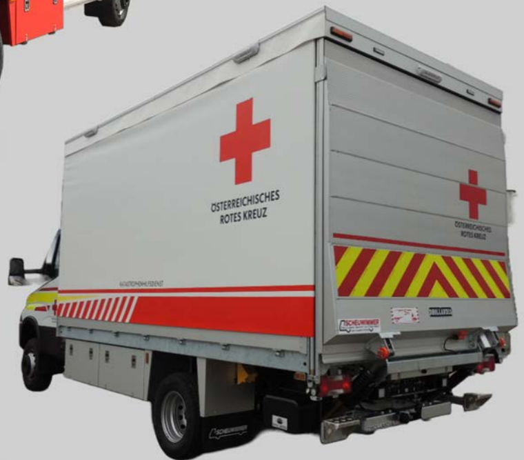
Schiebepanele statt Klappe, wenn der Platz zum Öffnen einer Klappe fehlt
