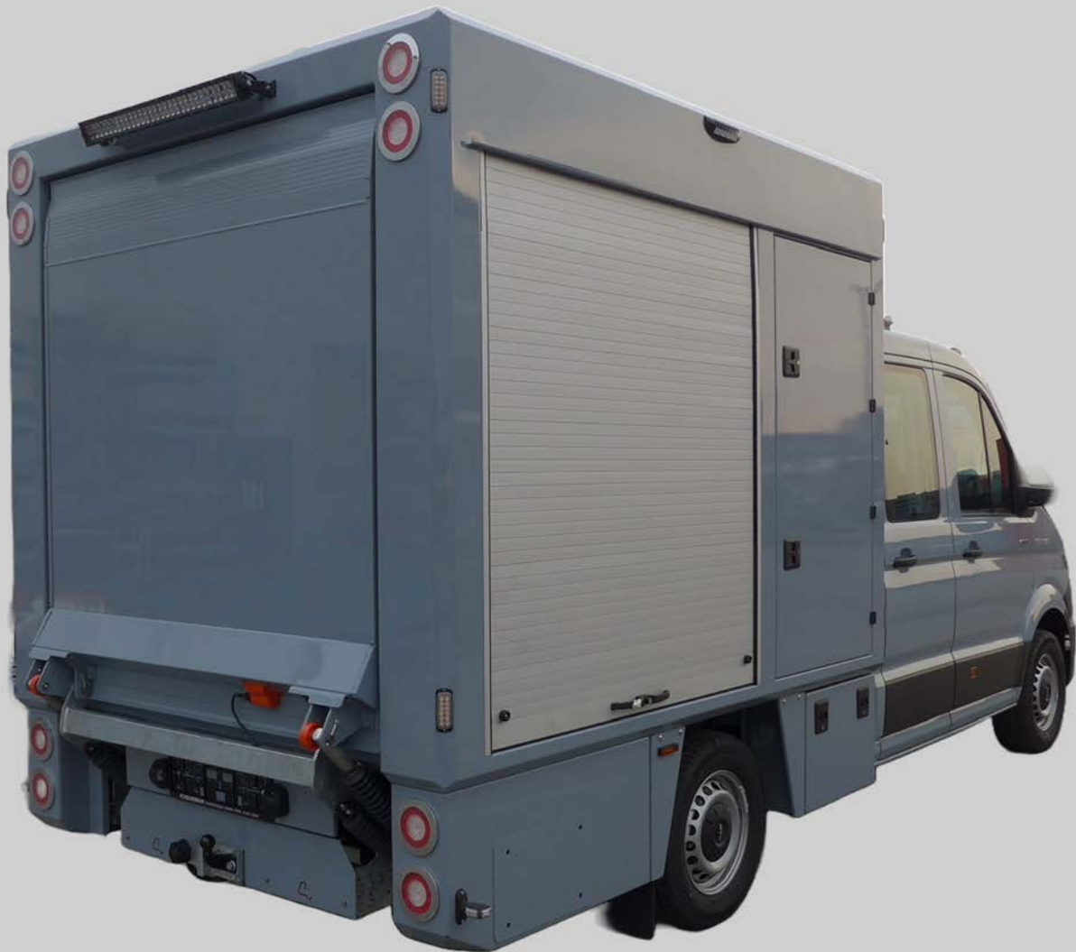
Kofferaufbau in Leichtbauweise mit Ladebordwand, Rollladen, Seitentüre, Werkzeugkasten
